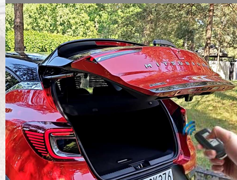
SYSTEM AUTOMATYCZNEGO OTWIERANIA I ZAMYKANIA BAGAŻNIKA PILOTEM
